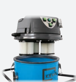
Filtro a cartucce idrorepellente in poliestere installato su KMB3.069 e KMB3.070
